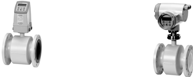
Sensorgehäuse und Flansche sind in Kohlenstoffstahl (ASTM A 105), der Klemmkasten ist in glasfaserverstärktem Polyamid oder optional in Edelstahl (AISI 316) ausgeführt. Das Messrohr besteht aus Edelstahl (AISI 304) und die Auskleidungen und Elektroden sind in einer Vielzahl verschiedener Werkstoffe verfügbar, wodurch der Sensor hochbeständig gegen eine große Bandbreite von Chemikalien ist.
